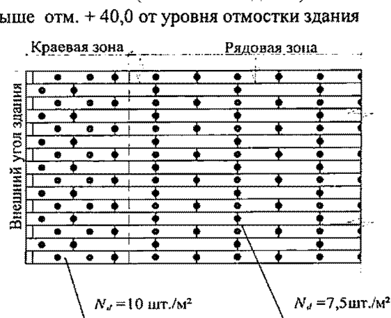
Пример раскладки теплоизоляционных плит размерами 1000×200 (ламельные изделия)
